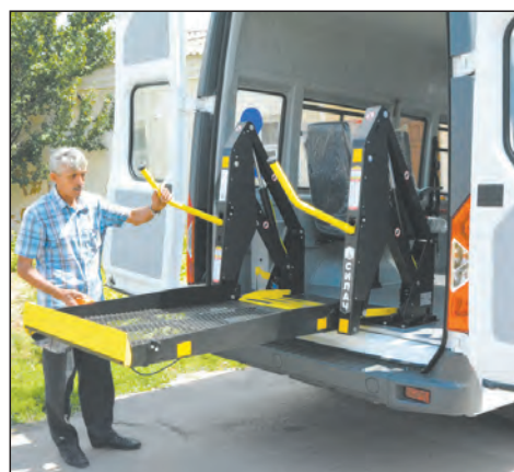
Система, позволяющая погрузить кресло-коляску
